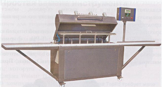
**Машина для вакуумной упаковки SBV-1250 изготовлена в основном из нержавеющей стали и может очищаться изнутри и снаружи мокрым способом.**
